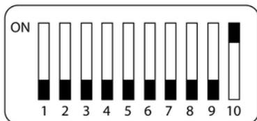
Lorsque le commutateur DIP 10 se trouve sur « ON », l'appareil travaille en mode DMX et est commandé par un contrôleur DMX.
