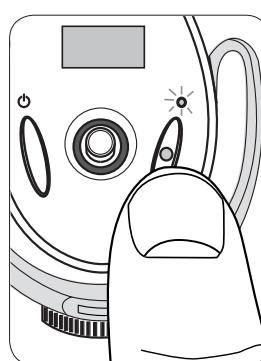
● **Gravar:** Pressione o botão record (gravar) para iniciar a gravação. O indicador LED permanece aceso durante a gravação. Pressione o botão record para criar uma nova faixa ou dar continuidade a uma gravação pausada.
