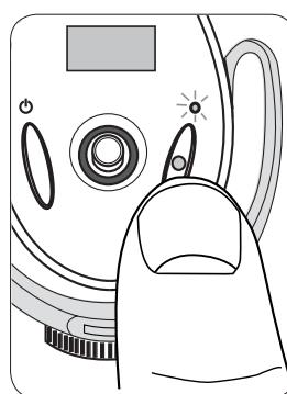
● **Enregistrer :** appuyer sur le bouton d'enregistrement pour lancer l'enregistrement. Le témoin LED s'allume pendant l'enregistrement. Lorsque l'on appuie sur le bouton d'enregistrement, une nouvelle piste est systématiquement créée, sauf si l'on reprend l'enregistrement après une pause.
