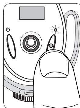
● **録音：**録音ボタンを押して録音を開始します。LEDインジケーターは録音中に点灯します。停止した録音を再開した場合以外は、録音を押すと新しいトラックが作成されます。
