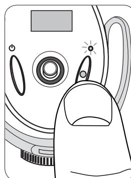
**Aufnehmen:** Die Aufnahmetaste drücken, um die Aufnahme zu starten. Während der Aufnahme leuchtet die LED-Anzeige. Durch Drücken der Aufnahmetaste wird immer eine neue Spur erstellt, es sei denn, eine pausierte Aufnahme wird fortgeführt.
