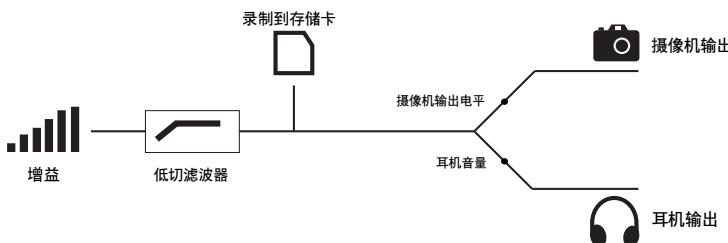
**重要提示：**按照说明执行操作，设定增益以获得最佳的信噪比性能。因为它在讯号路径中的第一位置，增益值将影响其后的所有讯号。禁止通过使用增益来增强或衰减耳机的讯号；可使用耳机音量调节部件调节监听电平。耳机和摄像机输出电平的调节均发生讯号到达设备的录音部分之后，如果增益设定太低或发生削波，不应用它进行补偿。
