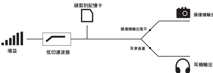
**重要資訊：**按照說明執行操作，設定增益以獲得最佳的信噪比性能。因為它在訊號路徑中的第一位置，增益值將影響其後的所有訊號。禁止通過使用增益來增強或衰減耳麥的訊號；可使用耳麥音量調節部件調節監聽電平。耳麥和攝像機輸出電平的調節均發生訊號到達設備的錄音部分之後，如果增益設定太低或發生削波，不應用它進行補償。
