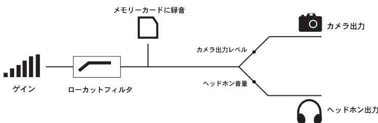
**重要：**最適な信号対雑音比を実現するにはゲイン設定の指示に従います。ゲインは、信号パスの最初であるため、それ以降のすべてに影響します。ゲインは、ヘッドホン信号のブーストや減衰には使用しないでください。ヘッドホン音量を使ってモニタリングレベルを調節してください。ヘッドホン出力とカメラ出力のレベル調節は、信号がデバイスの録音セクションに到達した後に行われます。ゲイン設定が低すぎる場合やクリッピングしている場合は、補正に使用しないでください。
