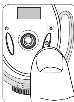
● **Registrazione:** per avviare la registrazione, premete il pulsante di registrazione. Durante la registrazione si illumina l'indicatore a LED. Premendo l'interruttore di registrazione viene sempre creata una nuova traccia, salvo in caso di riavvio di una registrazione in pausa.
