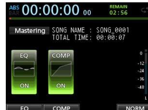
Den Masteringmodus erkennen Sie am Schriftzug **Mastering** oben links auf der Hauptseite.
