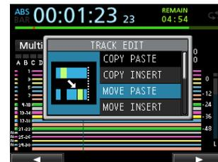
Mit dieser Funktion schneiden Sie das Audiomaterial zwischen dem IN- und OUT-Punkt der Quellspur aus und fügen es überschreibend am TO-Punkt der Zielspur ein. Durch diese Funktion entsteht Stille zwischen dem IN- und OUT-Punkt der Quellspur.
