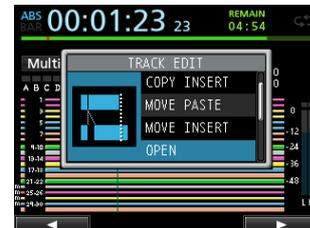
Diese Funktion entspricht dem Aufnehmen von Stille zwischen dem IN-Punkt und OUT-Punkt der gewählten Spur(en).
