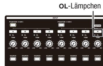
Sobald Sie die Gitarre anschlagen, können Sie den Eingangspegel auf dem Display anhand der Pegelanzeige von Spur 1 (TRACK 1) überprüfen.
