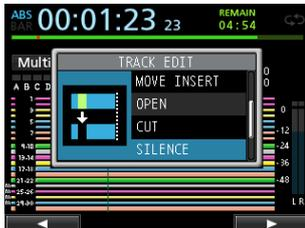
Mit dieser Funktion entfernen Sie das Audiomaterial zwischen dem IN- und dem OUT-Punkt der ausgewählten Spur und ersetzen es durch Stille.
