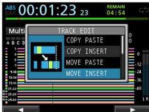
Mit dieser Funktion schneiden Sie das Audiomaterial zwischen dem IN- und OUT-Punkt der Quellspur aus und fügen es nichtüberschreibend am TO-Punkt der Zielspur ein. Durch diese Funktion entsteht Stille zwischen dem IN- und OUT-Punkt der Quellspur.
