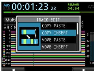
Mit dieser Funktion Sie das Audiomaterial zwischen dem IN- und OUT-Punkt der Quellspur und fügen es nichtüberschreibend am TO-Punkt der Zielspur ein. Der Inhalt der Quellspur zwischen dem IN- und dem OUT-Punkt wird durch den Vorgang nicht verändert.
