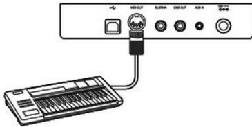
➔ Bei MIDI-Verbindungen wird das Gerät, das andere Geräte steuert, als Master bezeichnet. Ein Gerät, das über MIDI angesteuert wird, heißt Slave. Der Ausgang MIDI OUT des Masters wird mit dem Eingang MIDI IN des Slaves verbunden.
