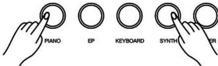
1. ➤ Halten Sie eine der Tasten *[PIANO]* / *[EP]* / *[KEYBOARD]* / *[SYNTH]* / *[OTHER]* gedrückt und drücken Sie anschließend eine weitere für den Layer (z.B. *[PIANO]* und *[SYNTH]*), um den Layer-Modus zu aktivieren.
