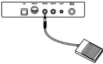
Über die Anschlussbuchse [SUSTAIN] können Sie ein Sustain-Pedal an das Digitalpiano anschließen.
