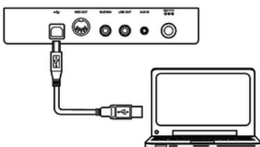
Über die USB-to-Host-Schnittstelle können Sie das Digitalpiano zum Austausch von Daten mit einem PC verbinden. Zudem können Sie das Digitalpiano mit Smartphones, Tablets oder anderen mobilen Endgeräten verbinden und mit Hilfe einer geeigneten App (z.B. **PianoToolBox**) steuern.
