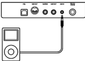
Über die Buchse [AUX IN] können Sie z. B. einen CD- oder MP3-Player an das Digitalpiano anschließen. Damit können Sie Musikstücke über die internen Lautsprecher des Digitalpianos wiedergeben und gleichzeitig dazu spielen. Stecken Sie ein Ende des Audiokabels in die Buchse [AUX IN] auf der Rückseite des Digitalpianos und das andere Ende in den Ausgang des entsprechenden Audiogeräts.
