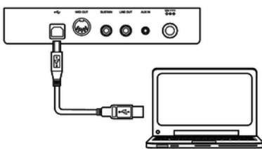
1. ➤ Verbinden Sie den USB-Anschluss des Digitalpianos über ein Standard-USB-Kabel (nicht im Lieferumfang enthalten) mit dem USB-Anschluss an Ihrem Computer.
