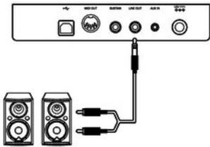
Über die Buchse [LINE OUT] können Sie das Digitalpiano an einen Verstärker, eine Stereoanlage, ein Mischpult oder ein Aufnahmegerät anschließen. Stecken Sie ein Ende des Audiokabels in die Buchse [LINE OUT] auf der Rückseite des Digitalpianos und das andere Ende in den Eingang des entsprechenden Audiogeräts.
