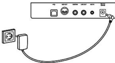
Verbinden Sie das Kabel am Netzteilanschluss mit der Eingangsbuchse [12V] auf der Rückseite des Pianos. Stecken Sie den Stecker des Netzkabels in eine ordnungsgemäß geerdete Netzsteckdose.
