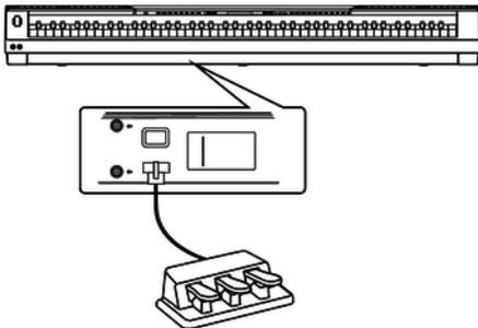
Über die Anschlussbuchse auf der Unterseite des Digitalpianos können Sie das Dreifach-Pedal (Sustain, Sostenuto und Soft) des optionalen Thomann Originalständers (Artnr. 352262) anschließen.
