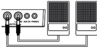
Verbinden Sie die Eingänge Ihres Verstärkers oder aktiven Monitors mit den Ausgangsbuchsen OUTPUT des Drum-Moduls. Wenn Sie einen Mono-Verstärker benutzen, verbinden Sie dessen Eingang mit der Ausgangsbuchse L/MONO des Moduls.
