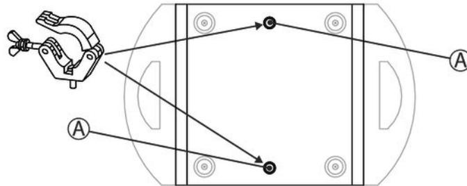
A Schnellverschlussöffnungen für Omega Brackets
