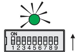
Sobald die Maschine DMX-Steuersignale empfängt, leuchtet die grüne **DMX-Signalanzeige** auf. Sie kann nun mit dem DMX-Controller betrieben werden.
