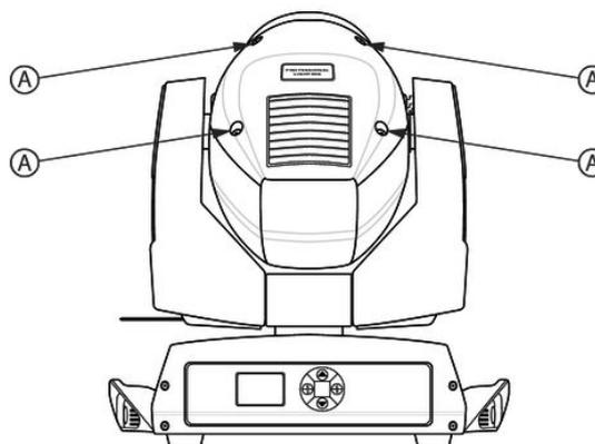
3. Abra la carcasa, desmontando los cuatro tornillos de cabeza con ranura cruzada de la tapa (ver ilustración anterior, "A"), y desmonte la parte superior. Procure que no se caiga ningún tornillo en el interior del equipo.
