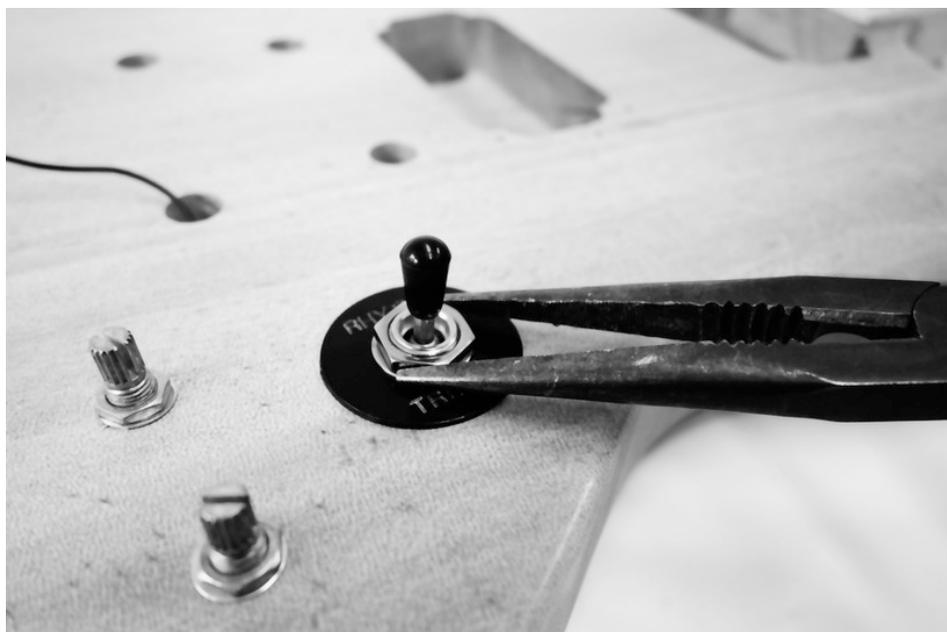
Ziehen Sie die Sechskantmutter der Potis mit einem passenden Ringschlüssel auf der Korpusdecke soweit fest, dass sich die Poti-Gehäuse nicht mehr verdrehen lassen.
