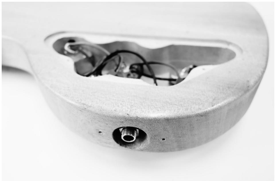
Setzen Sie die Halterung für die Ausgangsbuchse ein und kontrollieren Sie den Überstand der Buchse. Diese muss soweit über die Halterung nach außen ragen, dass sie mit der mitgelieferten Mutter ausreichend festgeschraubt werden kann und nur minimal übersteht. Korrigieren Sie den Überstand gegebenenfalls, indem Sie die Kontermutter im Inneren entsprechend verdrehen.
