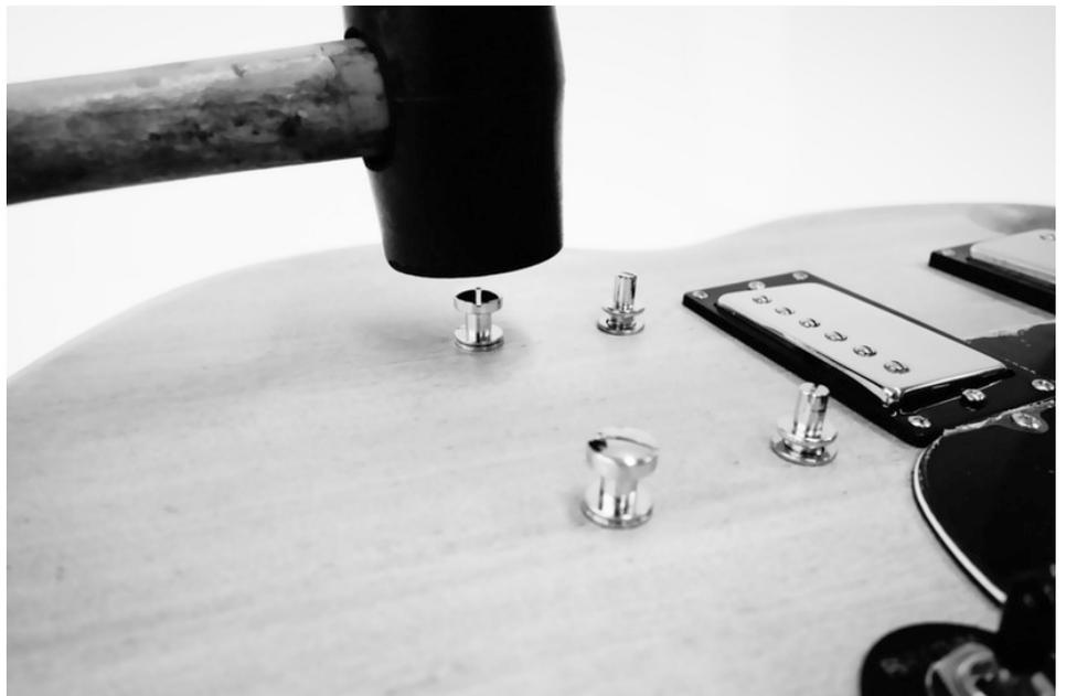
Setzen Sie den Saitenhalter und den Steg auf die Befestigungsbolzen. Diese beiden Bauteile sind noch lose und werden erst beim Besaiten der Gitarre fixiert.
