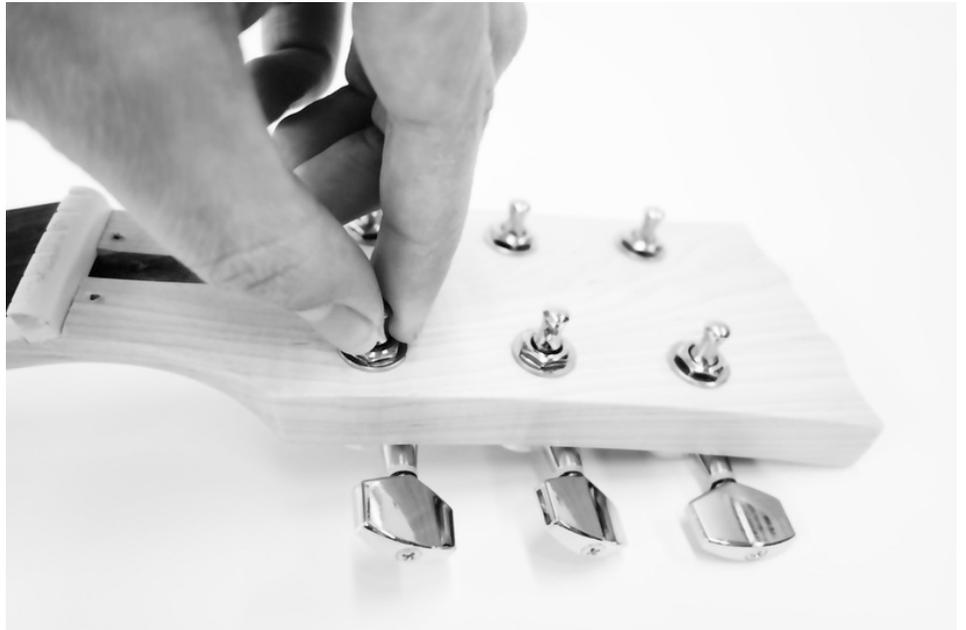
Ziehen Sie die Muttern auf der Vorderseite mit einem passenden Schraubenschlüssel, und anschließend die Schrauben zum Fixieren der Mechaniken auf der Rückseite fest an.
