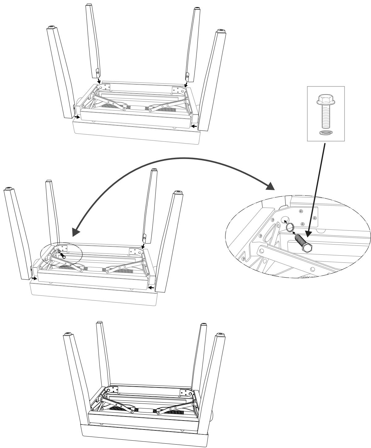
Ziehen Sie die Schrauben zunächst leicht an. Stellen Sie die Bank in der gewünschten Position auf den Boden, sodass sie stabil steht.
